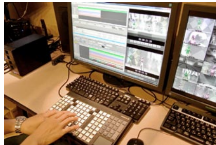
マルチオフラインキーボードは、膨大な撮影素材の中から最も魅力的な映像を簡単な操作で選択できる
